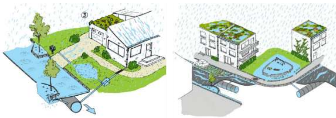
Figuur 9. Extreme neerslagafvoer: gecontroleerd overstromen © Aquafin
