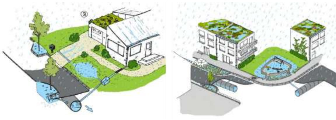
Figuur 8. Opvang en vertraagd afvoeren van hemelwater bij een norm neerslagafvoer © Aquafin
