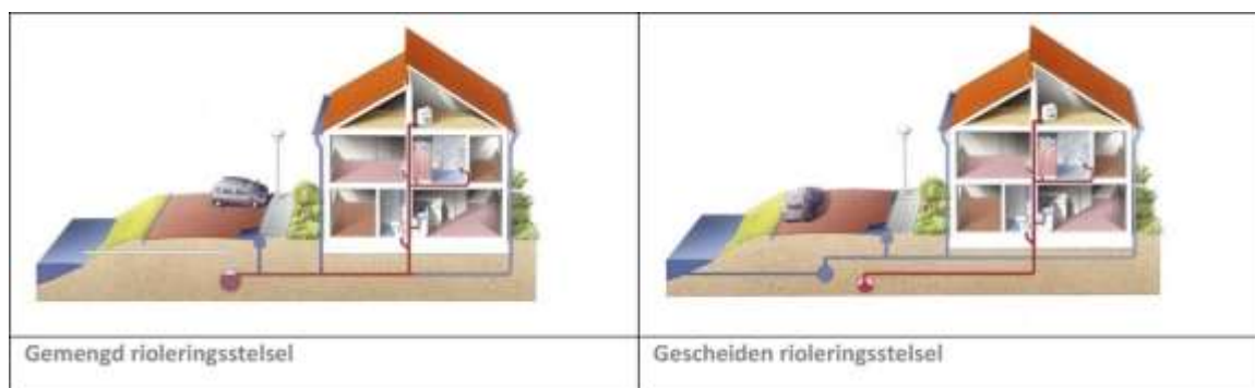
Figuur 5. Het verschil tussen een gemengd en een gescheiden stelsel. (a) Een gemengd stelsel: hemelwater en afvalwater worden via eenzelfde riool afgevoerd naar de waterzuivering. (b) Een gescheiden stelsel: hemelwater en afvalwater worden via een aparte riolering afgevoerd. Het afvalwater gaat naar de waterzuivering, het hemelwater gaat naar een waterlichaam of groenzone (gracht, waterloop, vijver, park, ...). © Aquafin
